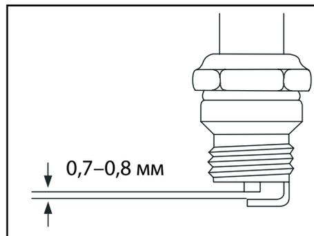
Зазор между электродами должен составлять 0,7–0,8 мм.
