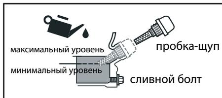
► проверьте наличие масла в картере двигателя, сняв крышку (с щупом) 7 горловины заправки масла. При наличии следов масла на щупе, проверьте уровень масла в картере: протрите щуп чистой сухой ветошью, установите щуп на место и снова выньте. Если уровень масла достаточен (между минимальной и максимальной метками щупа), доливать масло не следует.
